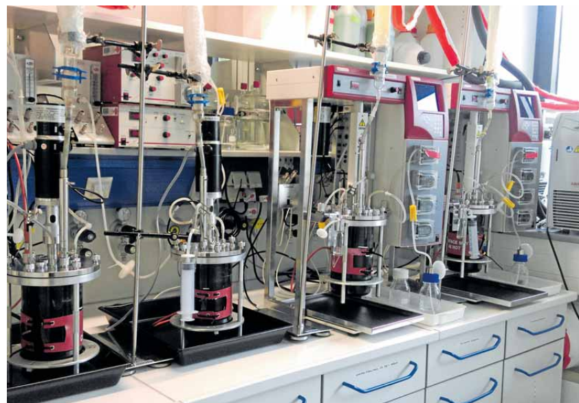
In diesen vier Bioreaktoren im Labor der Bundesanstalt für Geowissenschaften und Rohstoffe (BGR) in Hannover liefen die Biolaugungsversuche mit dem Sulfobacillus harzensis. Foto: BGR
